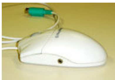
Foto 20 – Mouse adaptado com plug
