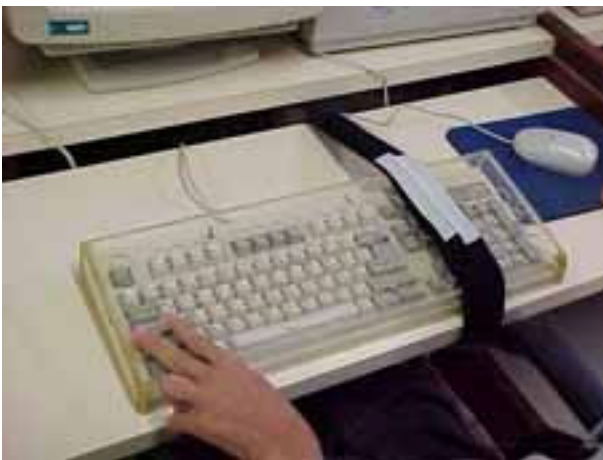
Foto 08 - Máscara de teclado encaixada no mesmo
