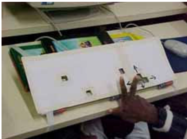
Foto 10 - Máscara de teclado com poucas teclas expostas
