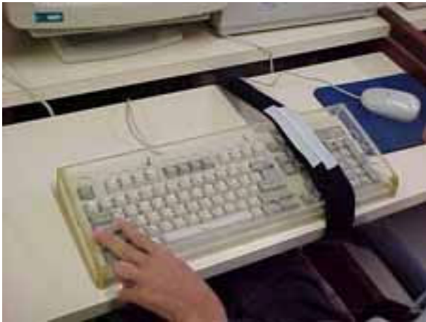
Foto 08 - Máscara de teclado encaixada no mesmo
