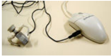
Foto 21 – Acionador confeccionado com botão liga/desliga de computador
