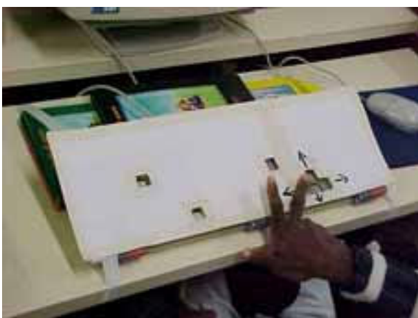
Foto 10 - Máscara de teclado com poucas teclas expostas
