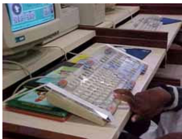
Foto 13 - Teclado com alteração na inclinação e fixado à mesa
