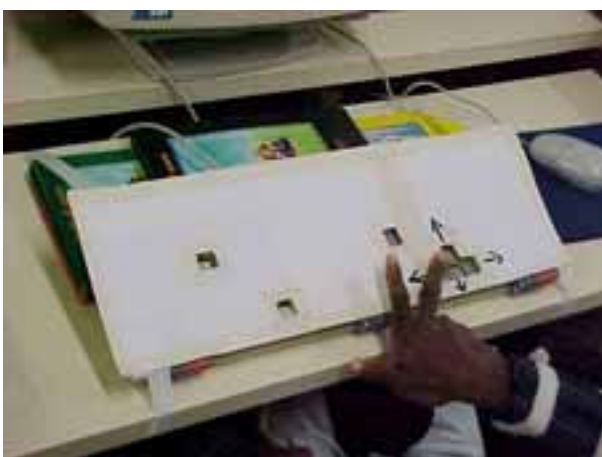
Foto 10 - Máscara de teclado com poucas teclas expostas
