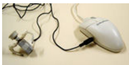
Foto 21 – Acionador confeccionado com botão liga/desliga de computador
