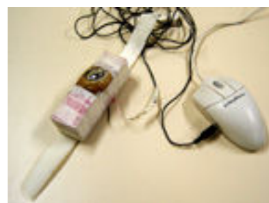
Foto 22 – Switches para acionamento com a cabeça, feito com botão grande de sucata
