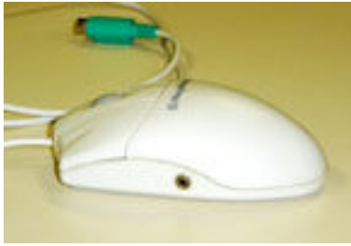
Foto 20 – Mouse adaptado com plug
