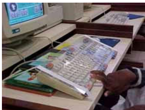
Foto 13 - Teclado com alteração na inclinação e fixado à mesa
