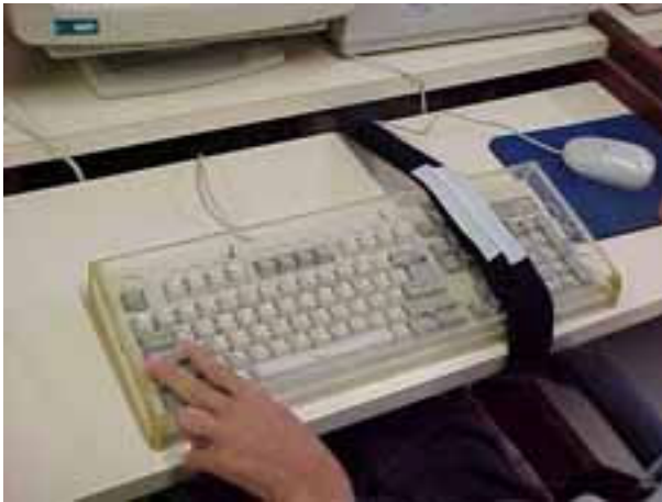
Foto 08 - Máscara de teclado encaixada no mesmo
