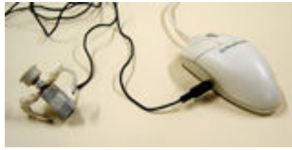
Foto 21 – Acionador confeccionado com botão liga/desliga de computador
